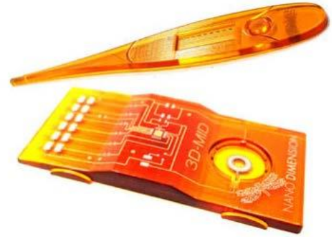
Plastik dış gövde ile devrenin birlikte oluşturulması
